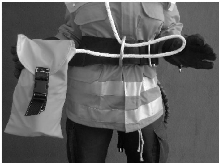
Der Halbmastwurf dient bei der Verwendung einer Feuerwehrleine als Bremsknoten beim Selbststretzen und zum Halten.
